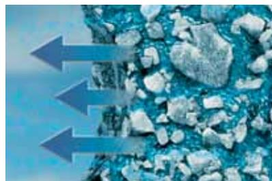
4. Bei sinkender Luftfeuchtigkeit wird die Feuchtigkeit sofort wieder an die Atmosphäre abgegeben. Die Fassade trocknet deutlich schneller und bietet Algen und Pilzen keinen Nährboden.
