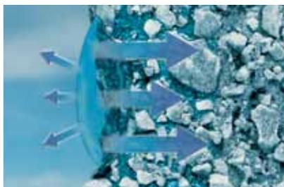
3. Putzoberflächen mit AquaBalance-Technologie dehnen die Wassertropfen und vergrößern so die Verdunstungsfläche. Überschüssige Feuchtigkeit wird vorübergehend in die Kapillaren aufgenommen.
