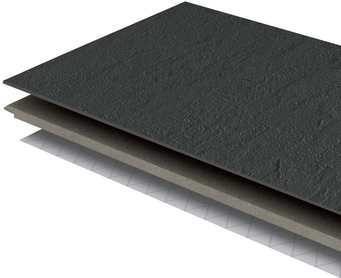
Drei unter Druck und Hitze fest miteinander verbundene Schichten bewirken die einzigartigen Eigenschaften der Nadura-Böden. An die Oberfläche aus einem extrem harten Holz-Mineralgemisch schließt sich die Kernlage an. Hier kommt eine AquaSafe-Spezialplatte aus besonderen Holzwerkstoffen zum Einsatz. Ein Nadura-Gegenzug stabilisiert den Aufbau. Nadura-Boden eignet sich auch für die Verlegung auf Untergründen mit kontrollierter Warmwasser-Fußbodenheizung.
