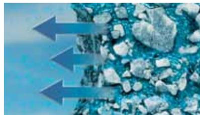
4. Bei sinkender Luftfeuchtigkeit wird die Feuchtigkeit sofort wieder an die Atmosphäre abgegeben. Die Fassade trocknet deutlich schneller und bietet Algen und Pilzen keinen Nährboden.
